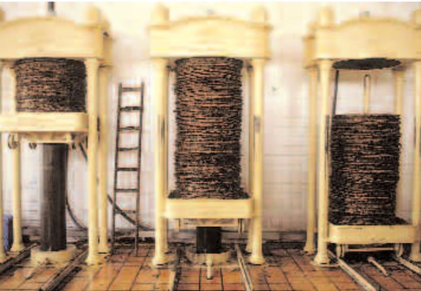
Las uvas pasificadas se prensan en la bodega por separado. Dada su consistencia, hay que utilizar prensas hidráulicas muy potentes para el segundo prensado, similares a las a las que se usan para obtener aceite. Los mostos fermentan en grandes tinajas de barro, y luego envejecen en barricas de roble por el sistema tradicional de soleras y criaderas.
